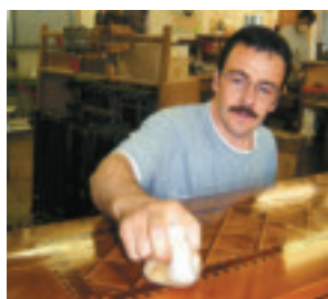
Ein Schreiner poliert einen Schrank mit Schellack.
